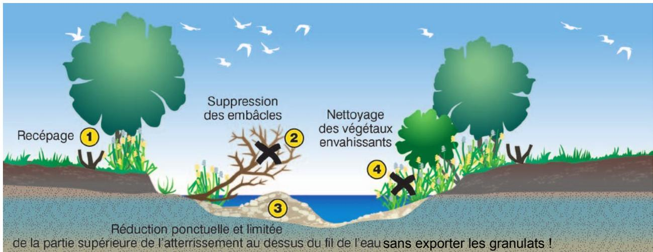
Ces opérations d'entretien léger ne nécessitent normalement pas la mobilisation de machines (ex : tractopelle, ...), susceptibles de dégrader les berges ou le lit du cours d'eau.
